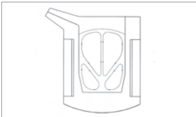
▲ شکل ۲- بردارها نشان‌دهنده الگو و مدل به هم خوردن مذاب در کوره القایی بدون هسته
